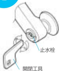
**2** 開閉工具でフィルターふたを左(反時計まわり)にまわして外し、フィルターを取出します。
